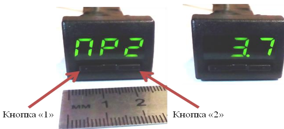
Рисунок 6.2 – Общий вид индикатора V-Button
