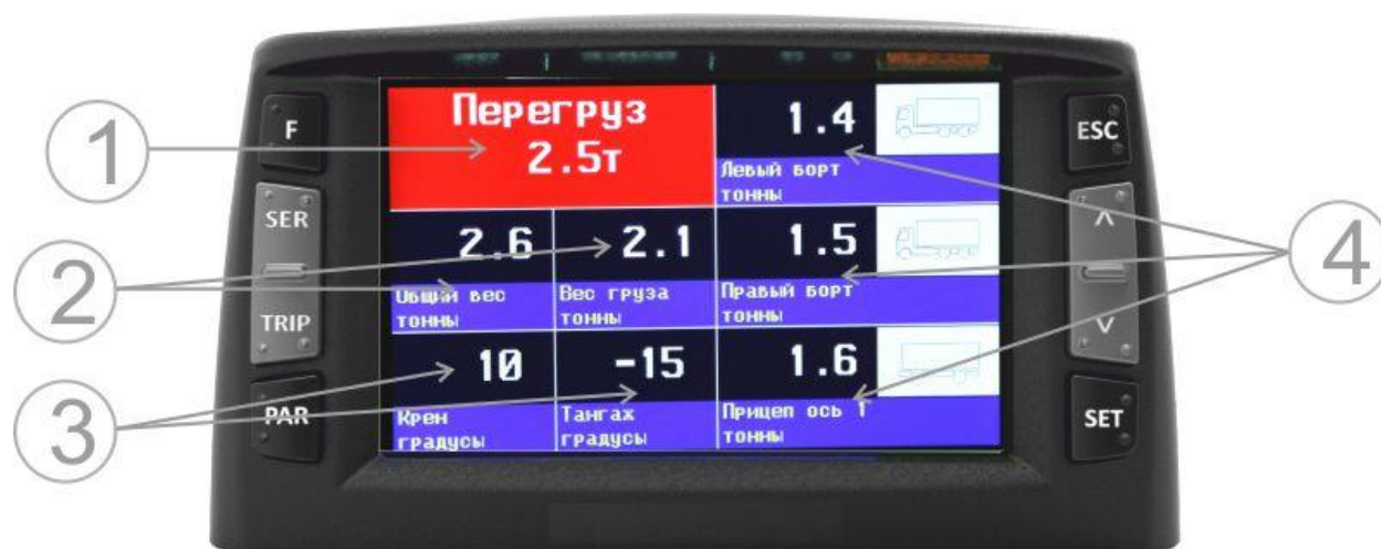
Рисунок 7.1 – Общий вид бортового компьютера V- Display. Экран «Нагрузки на оси»
